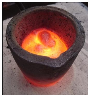
Abb. 3: Reaktionsprodukt – glühendes Eisen mit Aluminiumoxid-Schlacke
